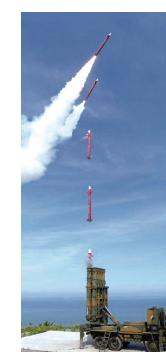
적 기술을 갖추고 있다. 유도탄은 빠른 반응시간 확보를 위해 전방 날개 조종형 형상 설계 및 제어기술, 연속 추력형 측주력 등 세계 최고 수준의 기술들이 적용됐다. 천궁Ⅱ는 대탄도탄과 대항공기 동시 교전은 물론 운용 중인 천궁과 발사대 단위 혼합 운용 등이 가능하기 때문에 우리 군의 미사일 방어 능력 향상에 크게 기여할 것이란 기대를 받고 있다. 또 국내 기술로 개발·배치함으로써 전력유지·강화는 물론 국방예산 절감도 기대된다.//
